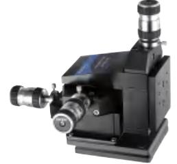
**规格:** X-Y-Z方向行程: 8 x 8 x 8mm; 运动方式: 线性移动; 丝杠精度: 700 Thread/ Inch;
